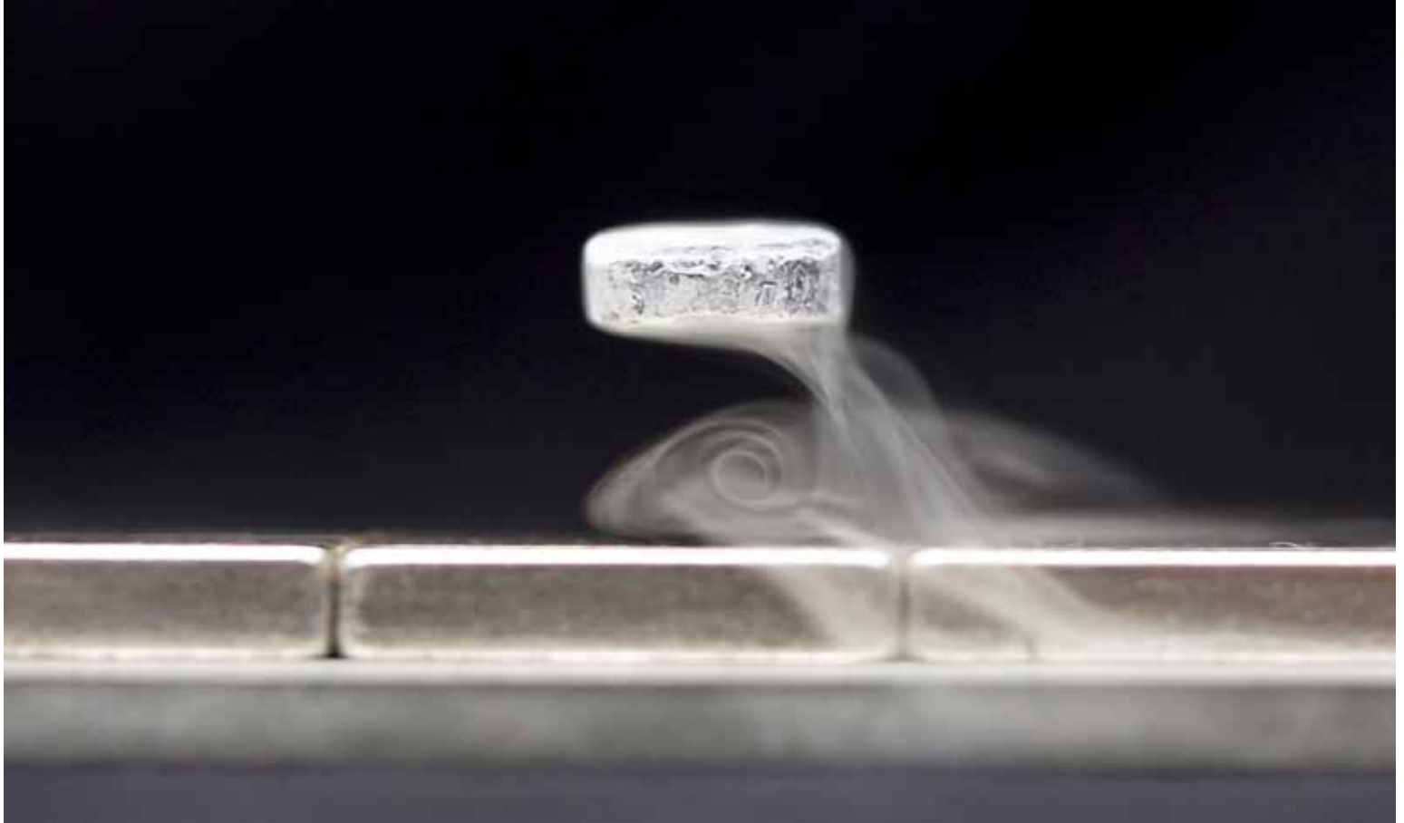
La lévitation, cette propriété qu'utilisent les trains à sustentation magnétique, est appelée «effet Meissner»: face à un champ magnétique (un aimant), le supraconducteur refroidi en-dessous de sa température critique génère un champ magnétique exactement opposé. Photo: J.Erard/UNIGE
